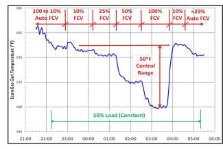
Fig. 12 CV-1 position vs EEGT.
