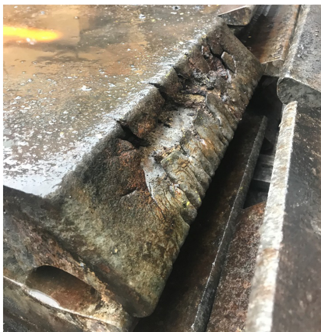
Et vandkølet DynaGrate-ristelement efter drift uden kølevand i ganske kort tid.
